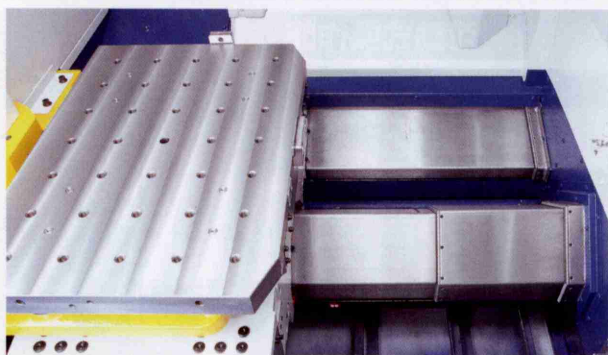
切りくずの堆積が少ない傾斜カバー。
